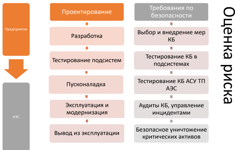
Рис. 3. Жизненный цикл работ по обеспечению кибербезопасности АСУ ТП АЭС на уровне подсистем
